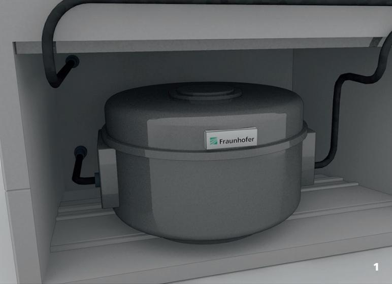
**1 + 2** So könnte ein magnetokalorisches Kühlsystem aussehen. Im Inneren erzeugt ein sich drehender Permanentmagnet ein magnetisches Feld, sodass die in Reihe geschalteten magnetokalorischen Segmente zyklisch erwärmt und wieder abgekühlt werden.
